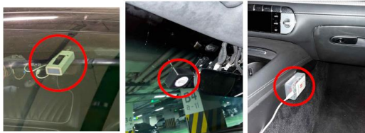
그림. 전방 MIC센서
