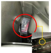
그림. 후방 G센서 (트렁크 내부)
